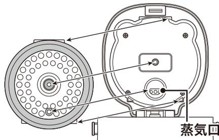
※誤った位置に取り付けると、調理時に蒸気が正しく排出されず、誤動作、故障の原因となります。
