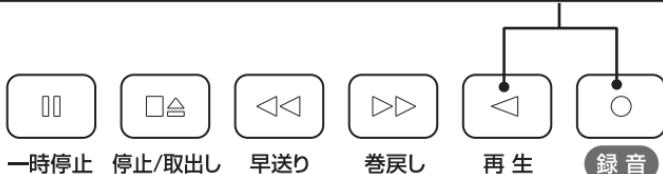
※録音中にテープが最後まで終わると、④-⑥録音ボタンと④-⑤再生ボタンが同時に上がり、録音が停止します。
